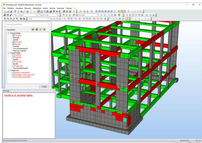
Al solito, in entrambi i casi, l'esito delle verifiche viene riportato sia in relazione di calcolo che mediante rappresentazioni grafiche degli indici di resistenza, utilizzando la colorazione come metodo per evidenziare prontamente l'esito positivo o negativo del processo di verifica.
