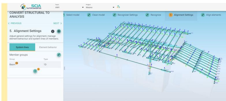
Il modello BIM strutturale viene caricato in Bimplus, viene trasformato nel corrispondente modello analitico mediante SCIA Autoconverter ed infine viene importato in MasterSap, dove può essere gestito e trattato con le ordinarie modalità.
