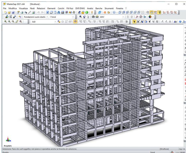
Il numero di modi richiesto con entrambe le metodologie è stato calibrato al fine di ottenere la medesima massa eccitata in entrambe le direzioni principali dell'azione sismica X e Y. Sintetizziamo di seguito i risultati ottenuti da entrambe le analisi:
